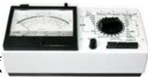
Рисунок 1.4 – Общий вид стрелочного комбинированного прибора
