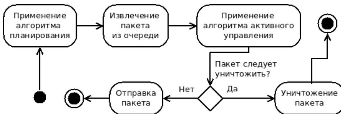
Рисунок 2 – Диаграмма активностей поведения механизма QoS при готовности отправки следующего пакета
