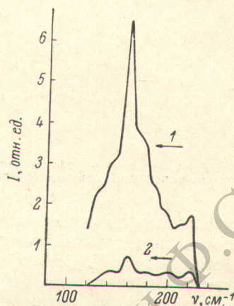
Рис. 2. Температурная зависимость интенсивностей линий КР второго порядка в интервале частот 120\div 250\text{ см}^{-1} .
