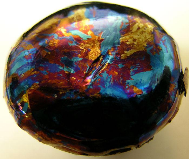
Эффект тонкой пленки на окисленной поверхности гафния
