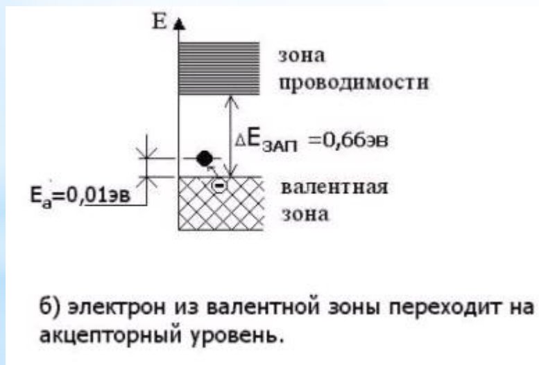
Рисунок 17 б – Зонная схема полупроводника с акцепторной примесью.
