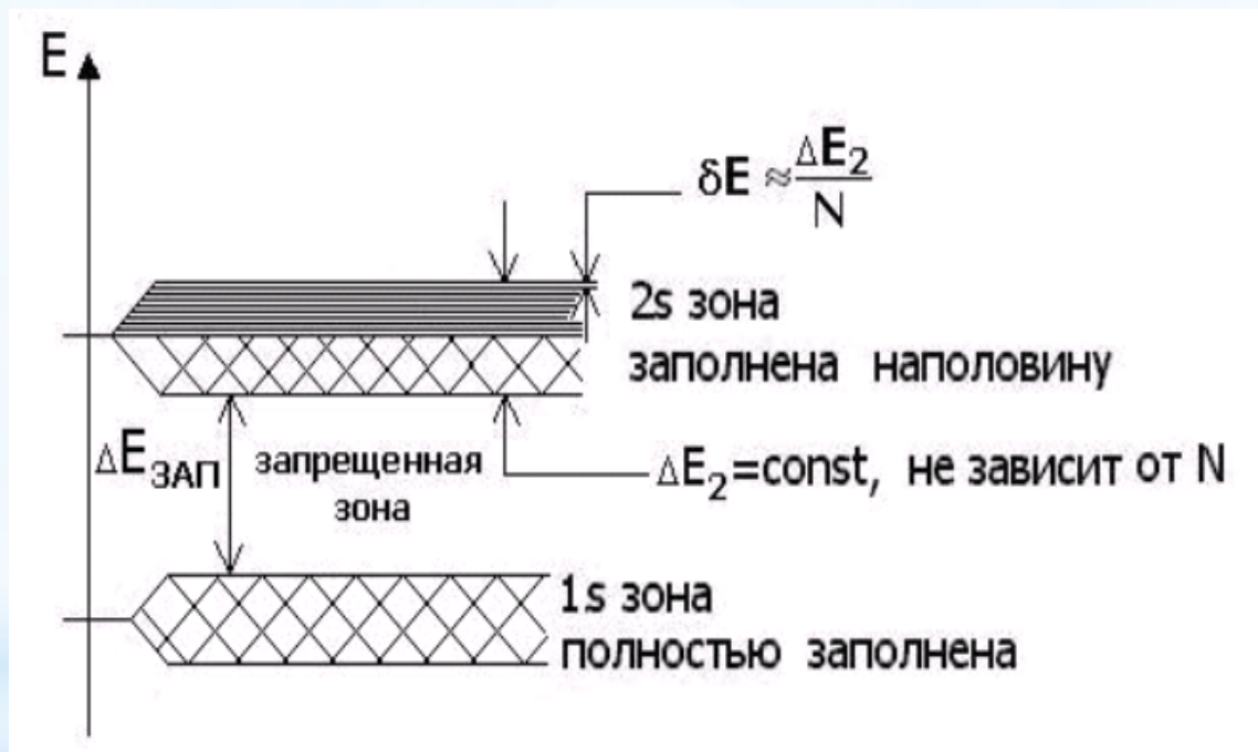
Рисунок 4 – Энергетическая схема системы, состоящей из N атомов лития.
