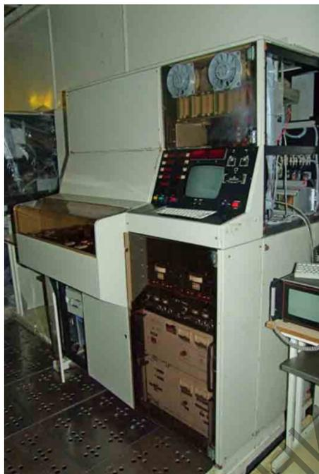
Рисунок 2 – Установка реактивно-ионного травления GIR 260S
