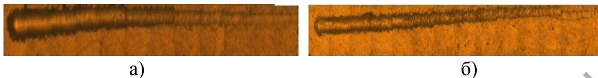
Рисунок 1 – Фрагменты морфологии поверхности после проведения скрэтч-анализа. а) исходное покрытие; б) царапина криогенно обработанная в течение 30 минут
