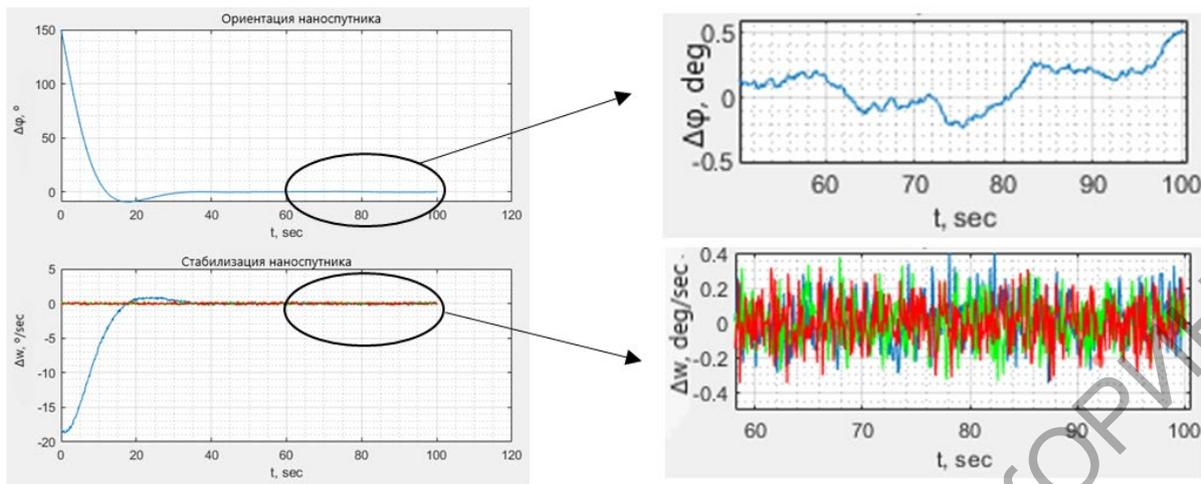
Рисунок 3 – Графики моделирования поворота и стабилизации макета
