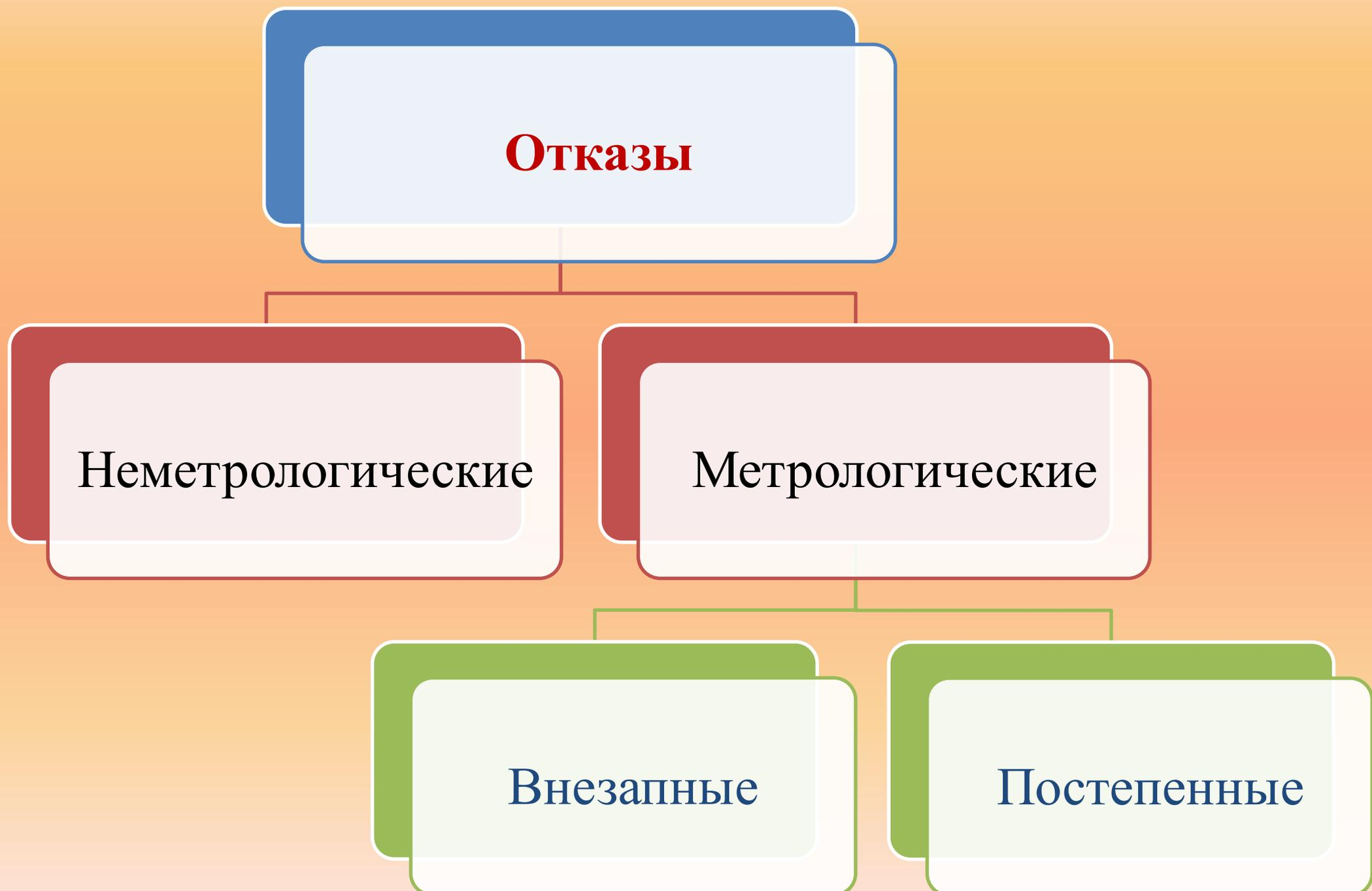
**Неметрологическим** называется отказ, обусловленный причинами, не связанными с изменением МХ средства измерений. Они носят главным образом явный характер, проявляются внезапно и могут быть обнаружены без проведения поверки.
