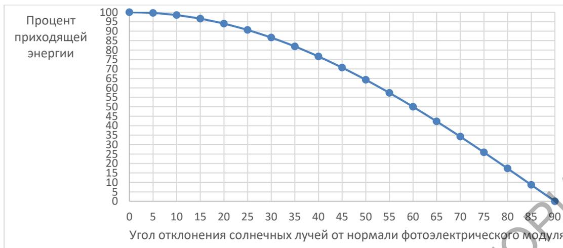
Рисунок 1 – Приходящая энергия от угла отклонения солнечных лучей
