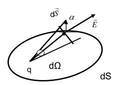
Выберем элемент некоторой поверхности dS.  $d\Omega$  - телесный угол под которым виден элемент поверхности dS; dS' = dScosa проекция dS на поверхность перпендикулярной вектору.
