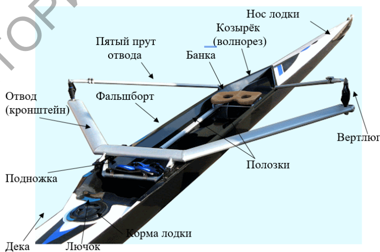
Рисунок 1 – Конструкция лодки
