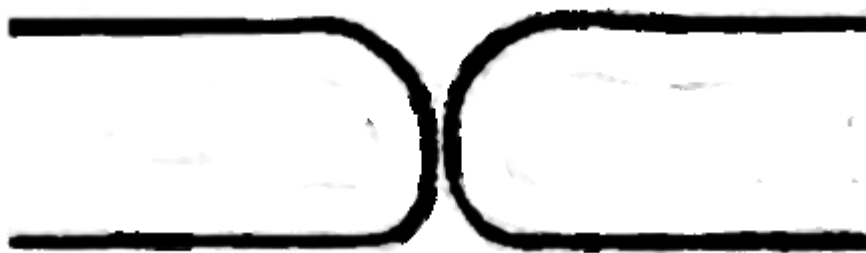
Рисунок 4-Небольшое оплавление краёв реза
