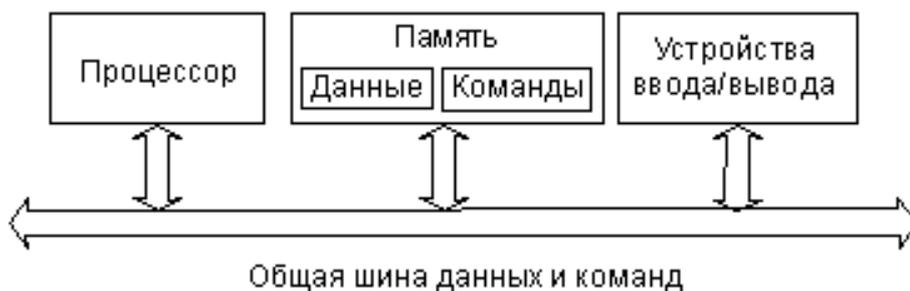
Рисунок 2 – Архитектура с общей шиной данных и команд
