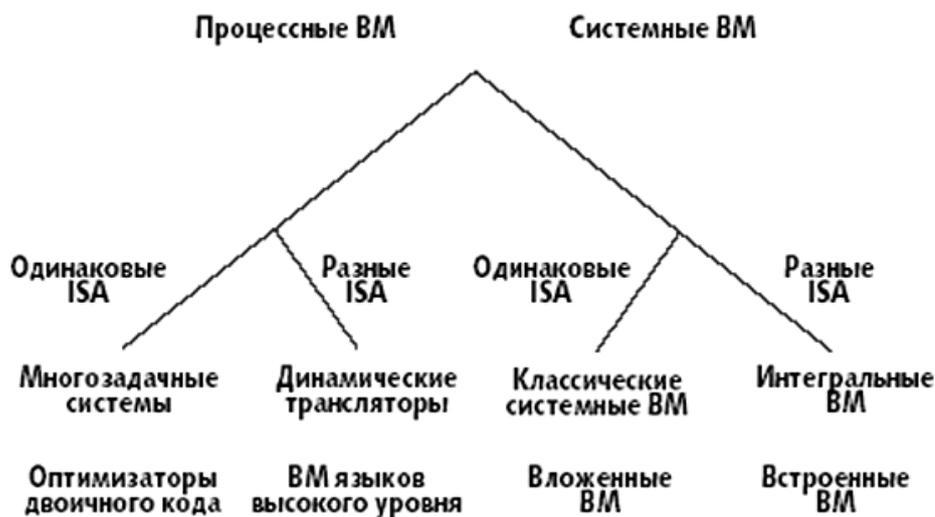
Рисунок 69 – Классификация виртуальных машин
