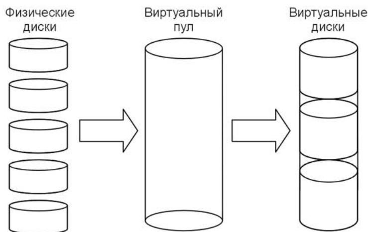
Рисунок 68 – Процесс преобразования физических дисков в виртуальный пул, а затем разбиения виртуального пула на виртуальные диски
