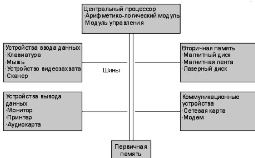
Рисунок 1 – Компоненты аппаратного обеспечения компьютера
