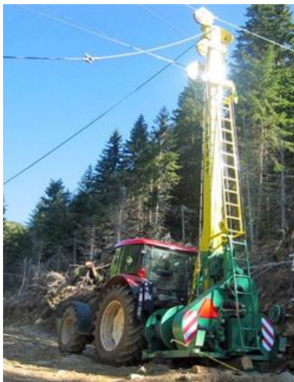
Рисунок 1 – Трелевочная канатная установка Larix 3Т
