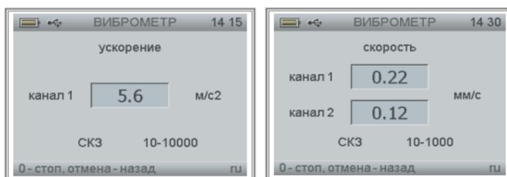
Рисунок 2 – Измерение параметров вибрации
