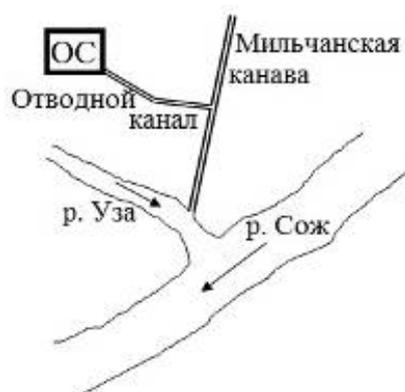
Рисунок 1 – Схема движения очищенных сточных вод от очистных сооружений к водоёмам-приёмникам [2]
