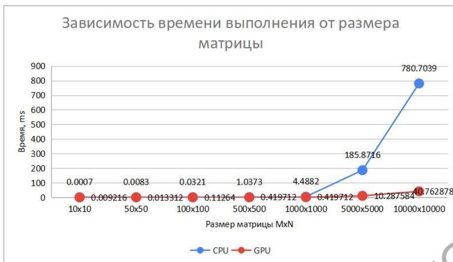
Рисунок 2 – Зависимость времени выполнения от размера используемых матриц
