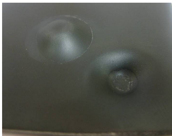
Рисунок 2.1 – Результат испытания на прочность \text{SiO}_2 покрытия армированного 30 масс.% порошка углерода при ударе
