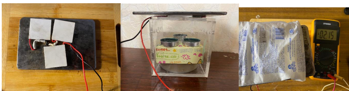
Рисунок 4 – Сборка учащимися источника тока на основе термоэлектрических явлений
