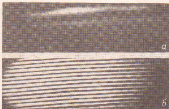
Рис. 1. Интерферограммы исходной настройки, полученные с помощью интерферометра с амплитудной дифракционной решеткой (а) и с помощью интерферометра с фазовой дифракционной решеткой (б).
