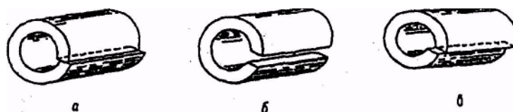
Рис. 1. Деформации упругого цилиндра, рассмотренные Вольтеррой: а, б — конфигурации, приводящие к образованию краевой дислокации; в — конфигурация, приводящая к образованию винтовой дислокации
