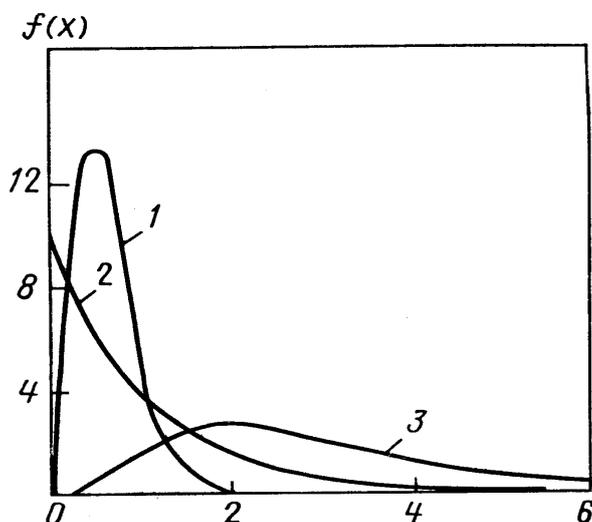
Рисунок 8.3 – Кривые гамма-распределения: 1 –  $a = 5; b = 3$ ; 2 –  $a = b = 1$ ; 3 –  $a = 1; b = 3$
