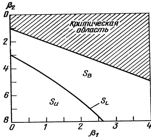
Рисунок 8.5 – График для выбора типа кривых Джонсона
