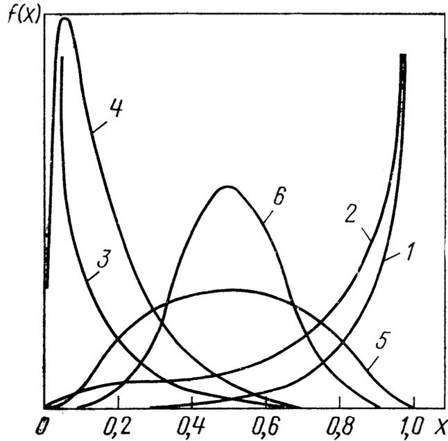
Рисунок 8.6 – Кривые распределения Джонсона типа  $S_B$  при  $\varepsilon = 0$ ,  $\lambda = 1$
