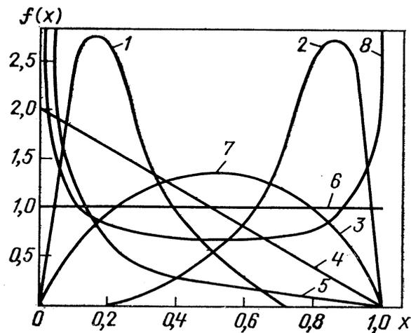
Рисунок 8.4 – Кривые бета-распределения 1 –  $a = 1,5, b = 5$ ; 2 –  $a = 5, b = 1,5$ ; 3 –  $a = b = 2$ ; 4 –  $a = 1, b = 2$ ; 5 –  $a = 0,2, b = 2$ ; 6 –  $a = b = 1$ ; 7 –  $a = b = 2$ ; 8 –  $a = b = 0,5$
