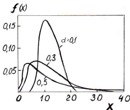
Рисунок 8.2 – Кривые логнормального распределения с различными параметрами  $\sigma_u$
