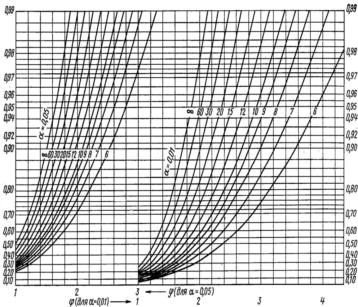
Рисунок 18.1 – График функции мощности  $F$ -критерия для  $k_1 = 7$
