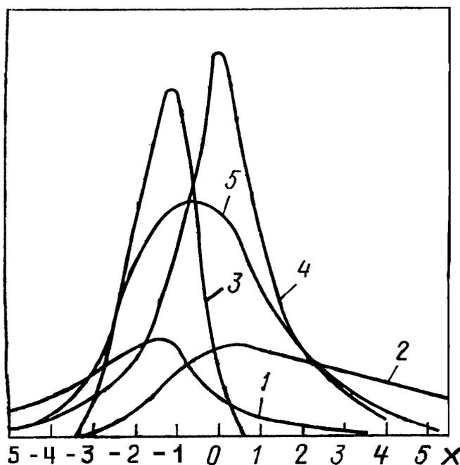
Рисунок 8.7 – Кривые распределения Джонсона типа  $S_U$  при  $\varepsilon = 0$ ,  $\lambda = 1$ :
