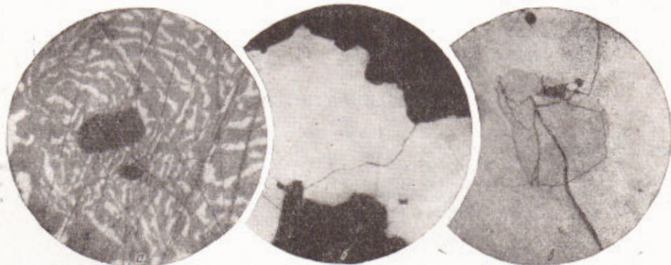
Рис. 1. а — моусонит (темно-серое) среди графических сростаний халькозина (серое) и галенита (белое); б — крупное включение моусонита (серое) на границе зерен галенита (белое) и сфалерита (темно-серое); черное — нерудный минерал; в — моусонит (темно-серое) в халькопирите (серое). а, б — Белоусовское месторождение, в — Золотушинское. а, в — 750×, б — 500×; в масле. Репрод. 2:3
