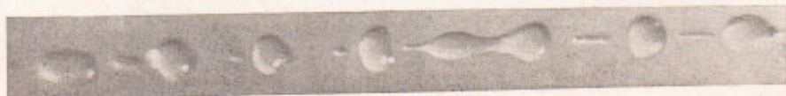
Рис. 3. Естественный распад струи жидкости на капли. Напор 0,54 м; диаметр отверстия 1 \cdot 10^{-3} м
