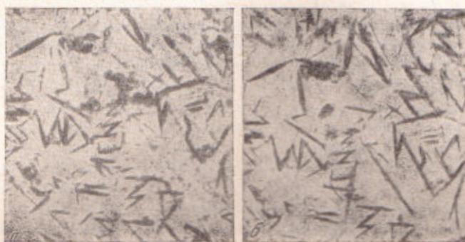
Рис. 3. Структура чугуна, закристаллизованного при давлении 30 кбар со скоростью 200^\circ/\text{сек} до (а) и после (б) травления 4% спиртовым раствором \text{HNO}_3 ( 170\times )
