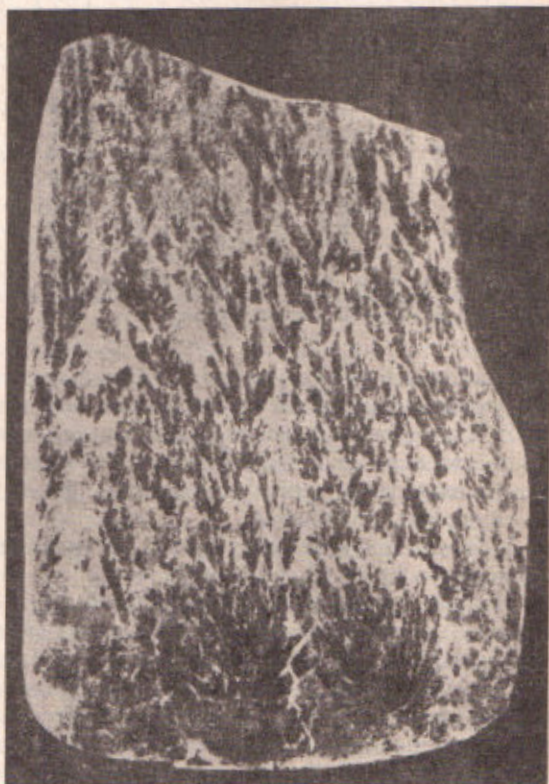
Рис. 2. Меланократовый базальт из нижней части Микчаидского покрова. Полированный штупф. Нат. вел. Удлиненные «елчатые» индивидуумы моноклинного пироксена четко выделяются на фоне мелкозернистой породы серого цвета
