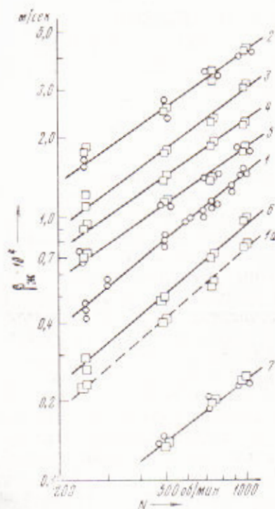
Рис. 1. Зависимости коэффициента массоотдачи от интенсивности перемешивания: 1 и 1а — вода (дистиллированная), 2 — n -гептан, 3 — четыреххлористый углерод, 4 — этанол (абсолютированный), 5 — изопропанол, 6 — пропиленкарбонат, 7 — гликоль. Кругики соответствуют опытам со стоком жидкости с поверхности контакта, а квадраты — опытам без протока жидкости
