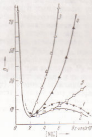
Рис. 1. Зависимость D от NO_3^- при экстракции урана (VI) 0,195 раствором Д-2-ЭГФК в CCl_4 : 1 — концентрация урана (VI) в исходной водной фазе 1,6 г/л; 2 — 4,25 г/л; 3, 4 и 5 — влияние высаливателей LiNO_3 , NaNO_3 и NH_4NO_3 в присутствии 2 M HNO_3 и 4,25 г/л урана (VI)
