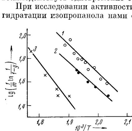
Рис. 2. Температурная зависимость активности для  $\text{Al}_2\text{O}_3$ : 1 — исходный, 2 — прокаленный образец (550°, 30 час.), 3 — прокаленный образец после модифицирования ацетоном
