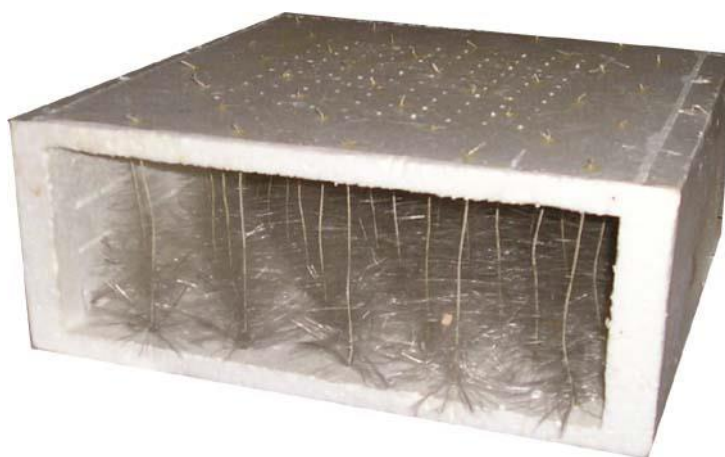
Рисунок 2.16. – Пенопластовый блок, содержащий конусовидные «ёлочки» из стекловолокна
