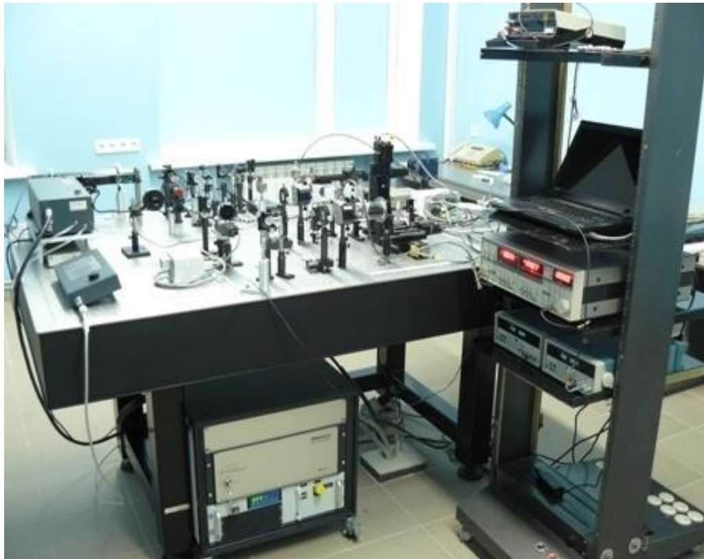
Рисунок 2.24. – Терагерцовый лазерно-оптический стенд, созданный в Институте физики НАН Беларуси
