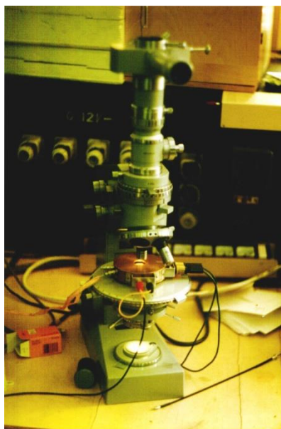
Рисунок 2.30. – Общий вид поляризационного микроскопа Carl Zeiss без приставки и фотокамеры
