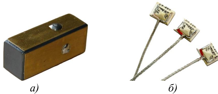
а – волновод; б – излучатели и приёмники ультразвука Рисунок 2.39. – Акустический волновод с нанесёнными на него электропроводящими обкладками, акустические излучатели и приёмники ультразвука на основе срезов кристалла кварца
