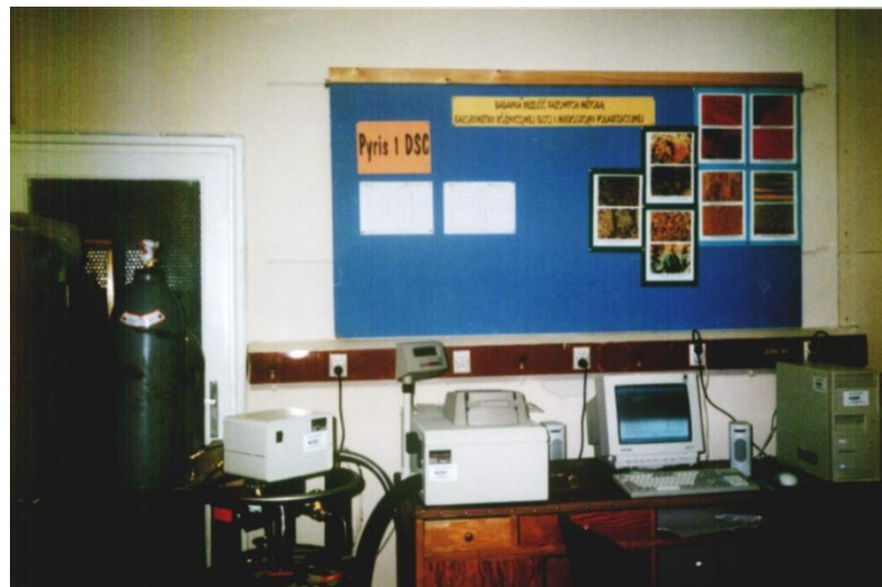
Дифференциальный сканирующий калориметр Pyris 1 DSC (в центре), установка для термального анализа CryoFill с баллонами жидкого азота (слева), управляющий компьютерный терминал (справа)
