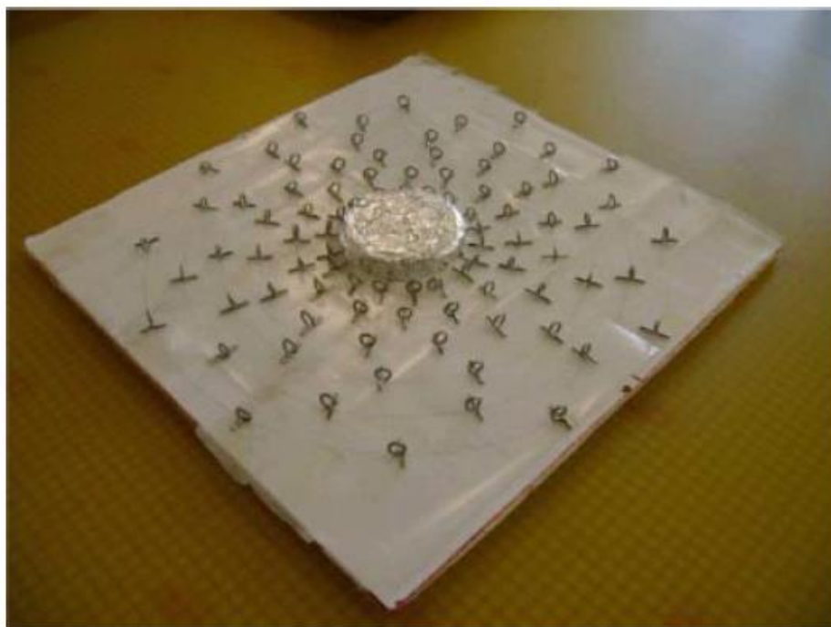
Рисунок 1.7. – Экспериментальный макет маскирующего устройства на основе канонических спиралей [109]
