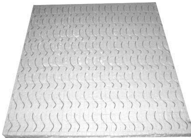
Рисунок 4.4. – Искусственный образец, содержащий правосторонние одновитковые спирали с углом подъема 53^\circ \pm 3^\circ
