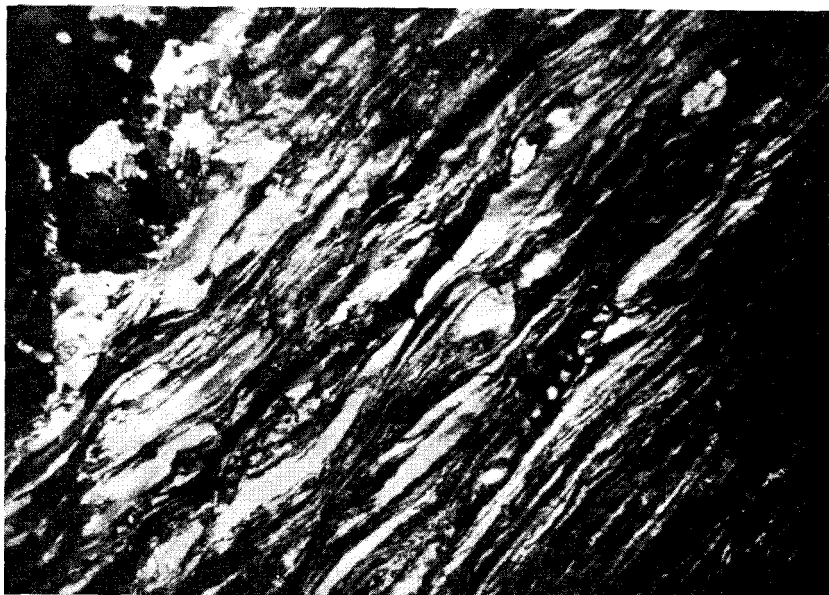
Рис. 1. Пластическая деформация кварцита. Переход к зоне интенсивной пластической деформации (правая часть снимка) сопровождается как изменением формы слагающих кварцит зерен кварца, так и изменением их оптической ориентировки (практически одновременное угасание зерен в зоне интенсивной пластичности). Поляризованный свет. 46 ×
