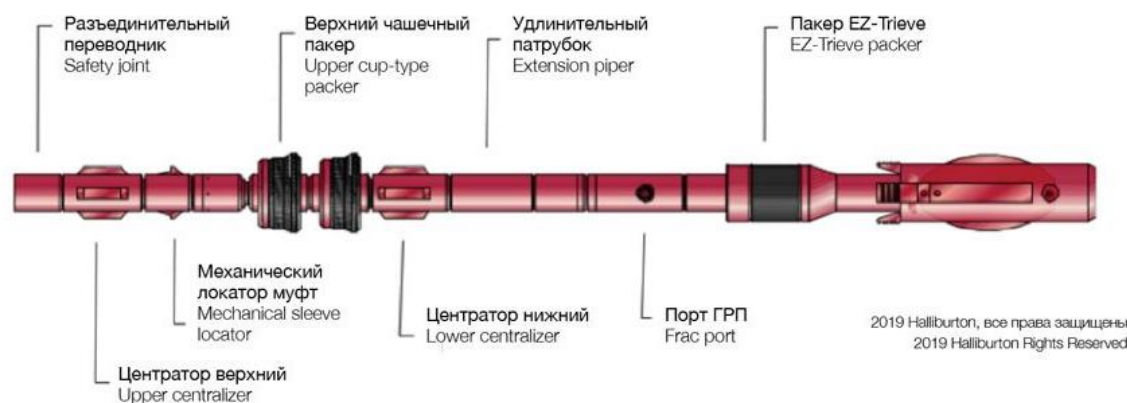
Рисунок 3 – Компоновка для МГРП с использованием селективного пакера
