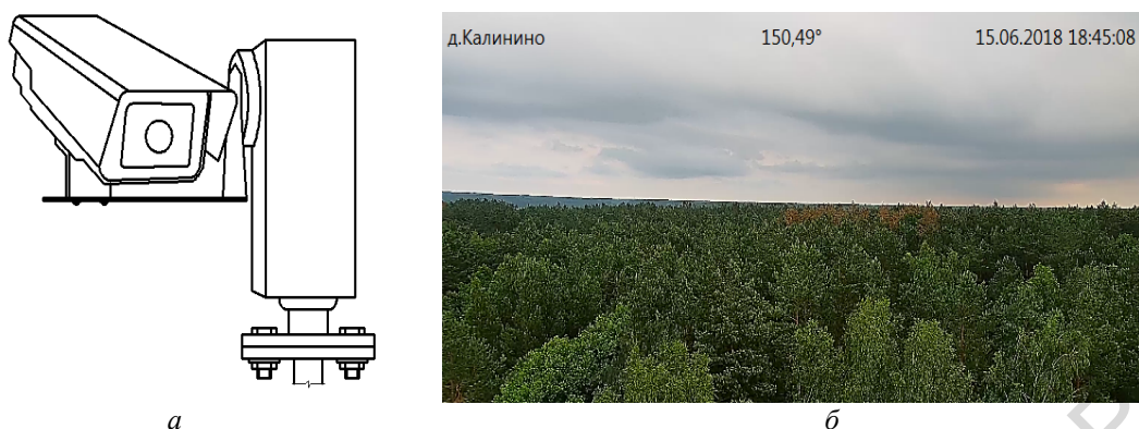
Рисунок 2.1 – IP-камера на опорно-поворотной платформе на вертикальном кронштейне: а – способ монтажа видеокамеры на опорно-поворотной платформе; б – панорама лесного массива без «мертвой зоны»
