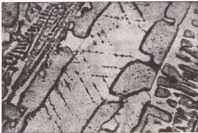
Рис. 2. Диффузия никеля при 900° в сплаве Ni 3 Al—Ni 3 Nb обычной кристаллизации. Авторадиограмма-реплика, 500×
