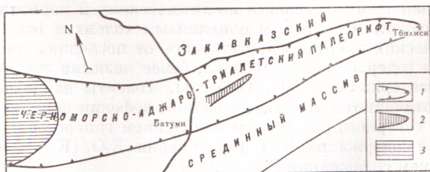
Рис. 1. Схема строения Черноморско-Аджаро-Триалетского палеорифта. 1 — граница палеорифта, 2 — толечтовые базальты ее осевой части, 3 — область отсутствия «гранитного» слоя
