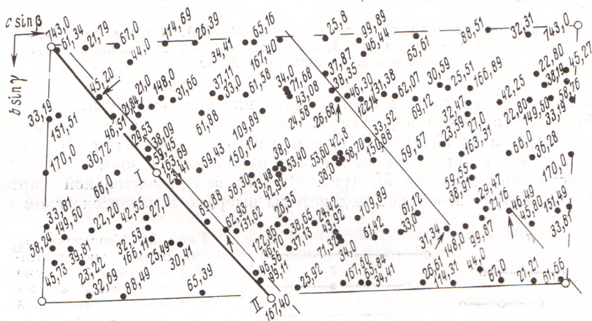
Рис. 1. P(uvw) в точечном виде; возле каждого пика две цифры: первая — мощность максимума в относительных единицах, вторая (через запятую) — высота u в сотых долях оси a ячейки. Выделены пики — концы векторов сдвига — I и II. Тонкими сплошными линиями показаны пятерки пиков, приведшие к возникновению на M_5 (рис. 26) слабых максимумов
