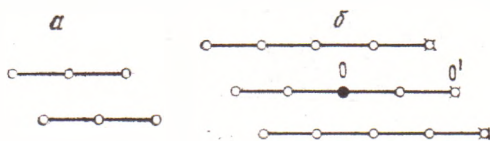
Рис. 3. Теоретическая диаграмма: тройки атомов в основной системе (а) и отвечающие им пятерки в векторной системе (б)
