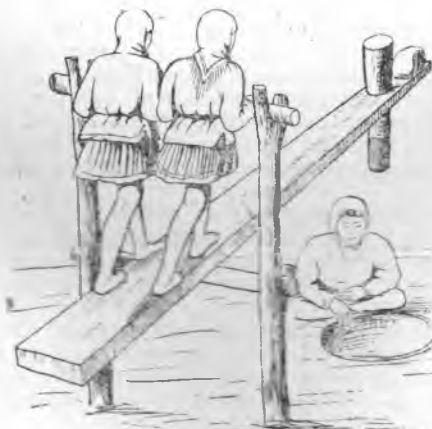
Рис. 6. Очистка риса от шалы у гияльков (приспособление называется Ин—Данг) (Аул Ободын-сар)
