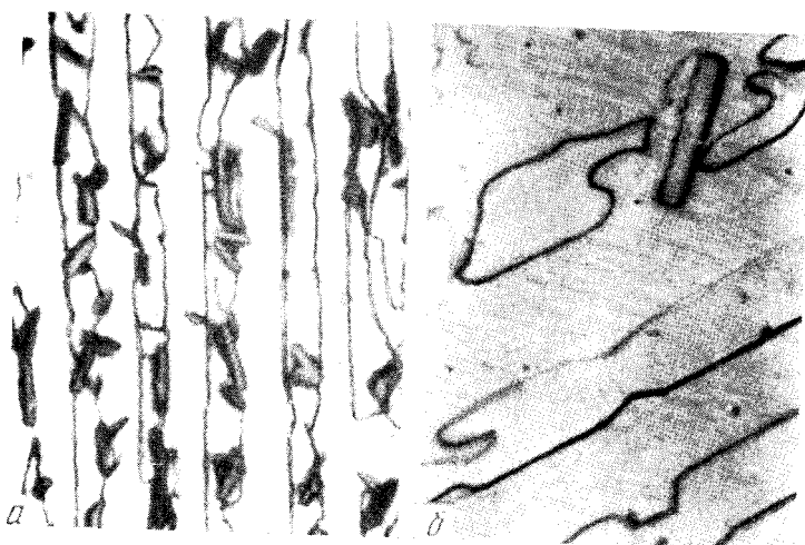
Рис. 3. Изменение формы пластин \delta -фазы под влиянием окисления (поверхностный слой, глубина 10 мкм): a — 1250\times , б — 2000\times
