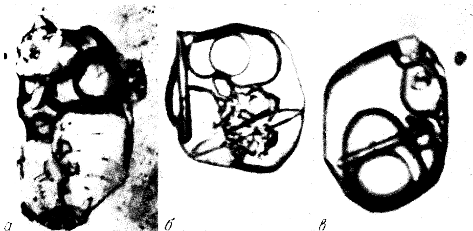
Рис. 2. Первичные включения растворов-расплавов из центральной (а), средней (б) и внешней (в) зон кристалла
