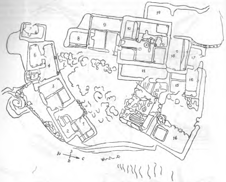
Рис. 9 (В. Ворониной и автора). План усадьбы Махмадулло Бека Кыргызова (жаун Толиби, кишлак Джамак, колхоз им. Молотова): 1, 5, 5 — кладовые гув ; 2 — аджра , или хуш-хона , — помещение для гостей; 3 — чордори — легкое помещение (в аджра и чордори живет Махмадулло Бек со своей второй женой и пятью детьми); 4, 8 — дализ — терраса, открытая с одной стороны; 7 — алоу-га , или от-хона — кухня; 8 — дарго — сени при входе в большой дом; здесь семья зачастую живет осенью и весной; 10 — куд — старый большой дом, где живет Абдурахман, сын Махмадулло, с семьей детьми; 11 — хуш-хона — дом для гостей, здесь живет сын Махмадулло Абукарим с двумя детьми; 12 — 14 — декун ( декин ) — глинобитные возвышения для отдыха и приема гостей в летнее время; 15 — ахуер — конюшня; 16, 18, 19 — ргут — хлев для мелкого скота; 17 — хаз — хлев для коров
