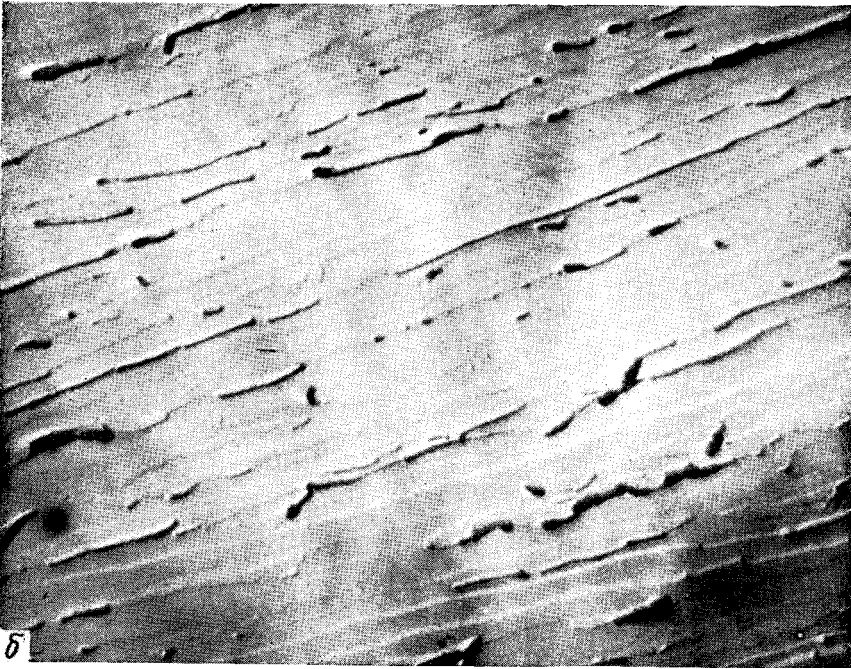
Рис. 1. Электронно-микроскопические снимки бесцветной (а) и почерневшей при нагревании (б) частей одного кристалла; поверхность скола по спайности (1011). 11 400×
