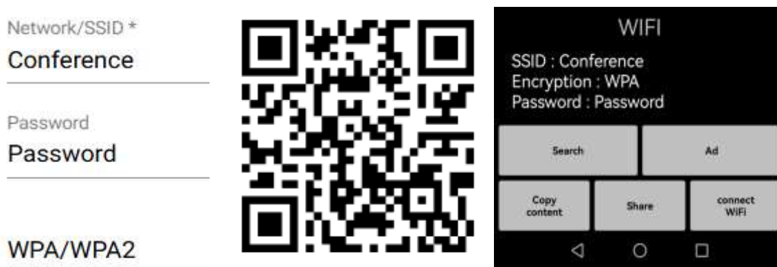
Рисунок 3 – Кодирование и декодирование QR-данных для сети WiFi
