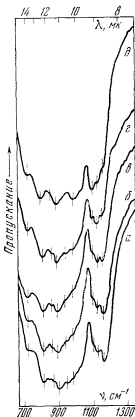
Рис. 3. И.-к. спектры поглощения твердых растворов муллита — корунда с C_{\text{т.р.}} (%): а — 1,5; б — 9,0; в — 14,0; г — 18,5; д — 22,5
