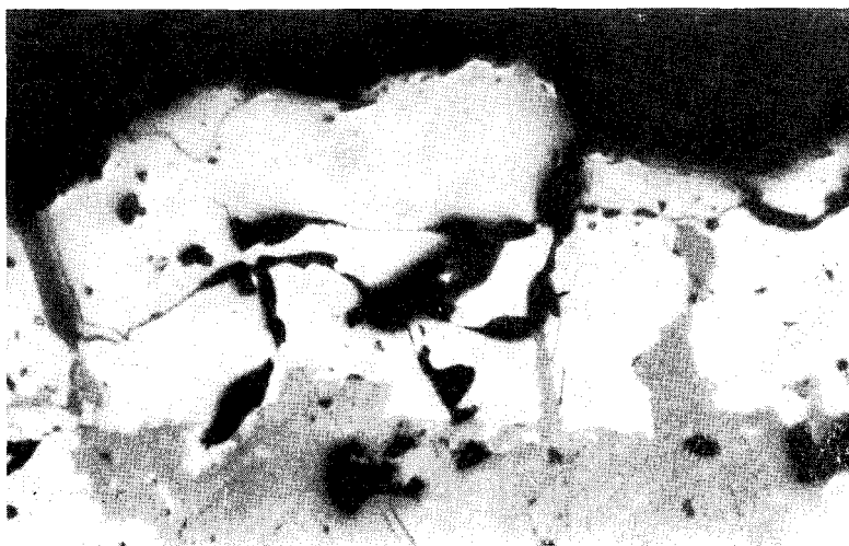
Рис. 2. Коррозия и замещение эггестонита (белое) каломелью (серое). Черное в эггестоните и каломели — каверны, заполнявшиеся металлической ртутью. Аншлиф. 100 \times . Без анализатора
