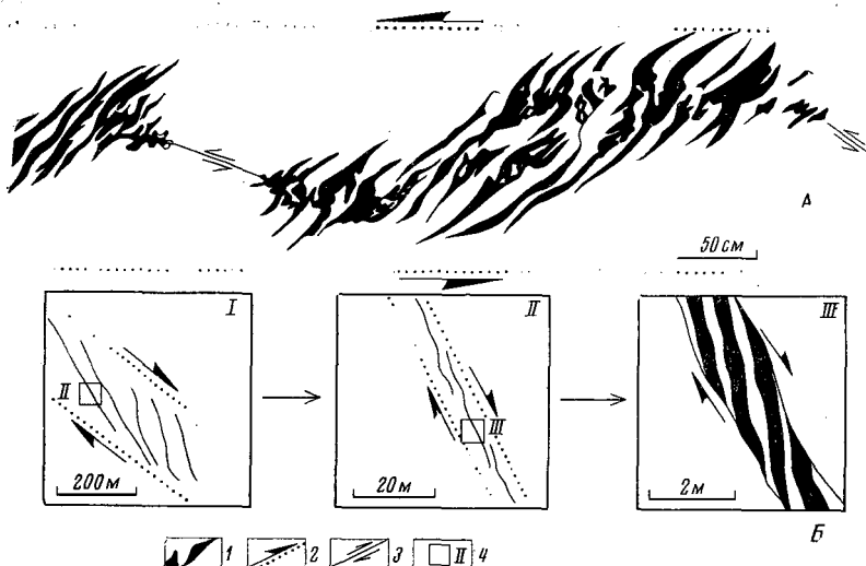
Рис. 3. Эшелонированная разрывная структура 2-го типа (А) и иерархия эшелонированных разрывных структур (В). I — часть плана рудного поля; II — деталь рис. 1; III — деталь рис. 2. 1 — жилы; 2 — условные границы потенциальных сдвигов (стрелкой показано направление смещения блоков); 3 — линии сдвигов и направление смещений по ним; 4 — контуры участков
