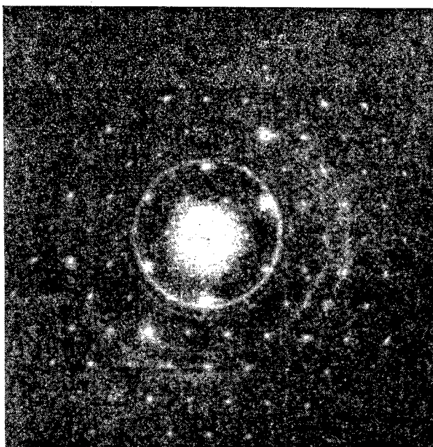
Рис. 3. Микродифракционная картина с извлеченного глинистого минерала
